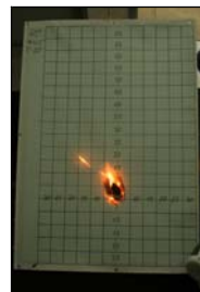
Фиг. 16. Наклон 40° посока на вятъра 45° Fig. 16. 40° inclination, wind direction 45°
