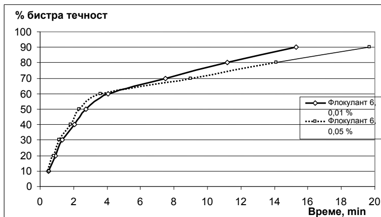
Фиг. 8. Резултати при утаяване с 0,05 % и 0,01 % р-ри на флокулант № 6 с доза 1 ml Fig. 8. Results from the precipitation with 0.05 % and 0.01 % solutions of flocculent № 6 with a dose of 1 ml
