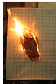
Фиг. 15. Наклон 40° посока на вятъра 90° Fig. 15. 40° inclination, wind direction 90°
