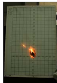
Фиг. 16. Наклон 40° посока на вятъра 45° Fig. 16. 40° inclination, wind direction 45°
